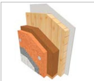
Die Verwendung einer äußeren zugelassenen Holzwerkstoffbeplankung bzw. einer Massivholzschalung unter dem WDVS ist zwar möglich, sie beeinträchtigt aber ggf. das Verdunstungspotential der Gesamtkonstruktion und wird daher in der Regel nicht empfohlen.
